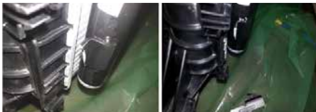
Obr. 1 – prasklé braketky na projektech AUDI MLB (levá strana) a VW RPU (pravá strana) / Ryc. 1 – pęknięte zaczepy na projektach AUDI MLB (lewa strona) i VW RPU (prawa strona)
