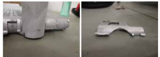
Obr. 1 – prasklé braketky na projektech AUDI MLB (levá strana) a VW RPU (pravá strana) / Ryc. 1 – pęknięte zaczepy na projektach AUDI MLB (lewa strona) i VW RPU (prawa strona)
